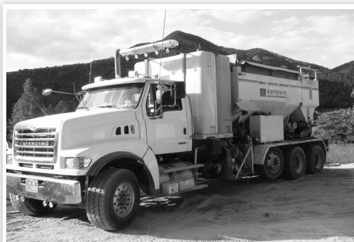
콘크리트 믹싱 장비(Mobile-mixer)
