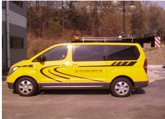
<그림 2.1> 노면 상태 조사 장비(PES)
